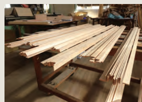
棧の素材。杉材を1,800×15×4mmの細長い棒材にしたもの。
