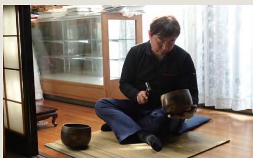
鳴り出し(音の調律工程)。混在する音色を整え、全体として正しく美しく「鳴る」ように、音を聞いては金槌で叩きながら調整してゆく。
