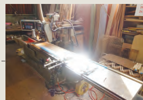
棒材を正確な角度で細かく切断して部品に仕上げる機械。
