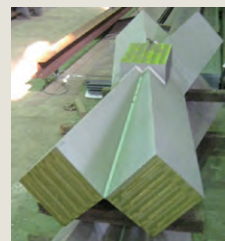
外周柱のX字接合部。
