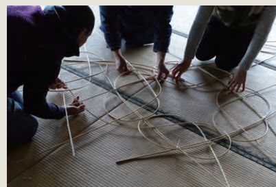
ロビー天井の中心部分。工房で仮組みをする。
