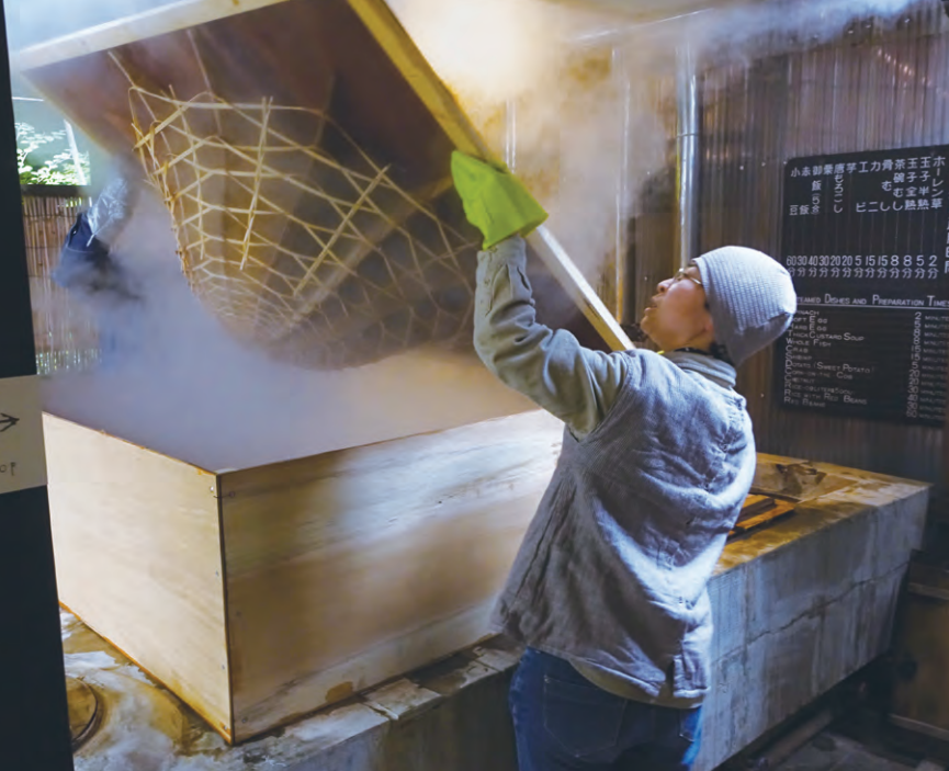
治具に取り付けた慈嶽堂天蓋中央部分を温泉蒸気の噴き出す「地獄蒸し」に入れて、形のクセをつける。
