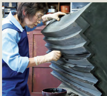
ひな壇見付け部分の地研ぎの工程。
