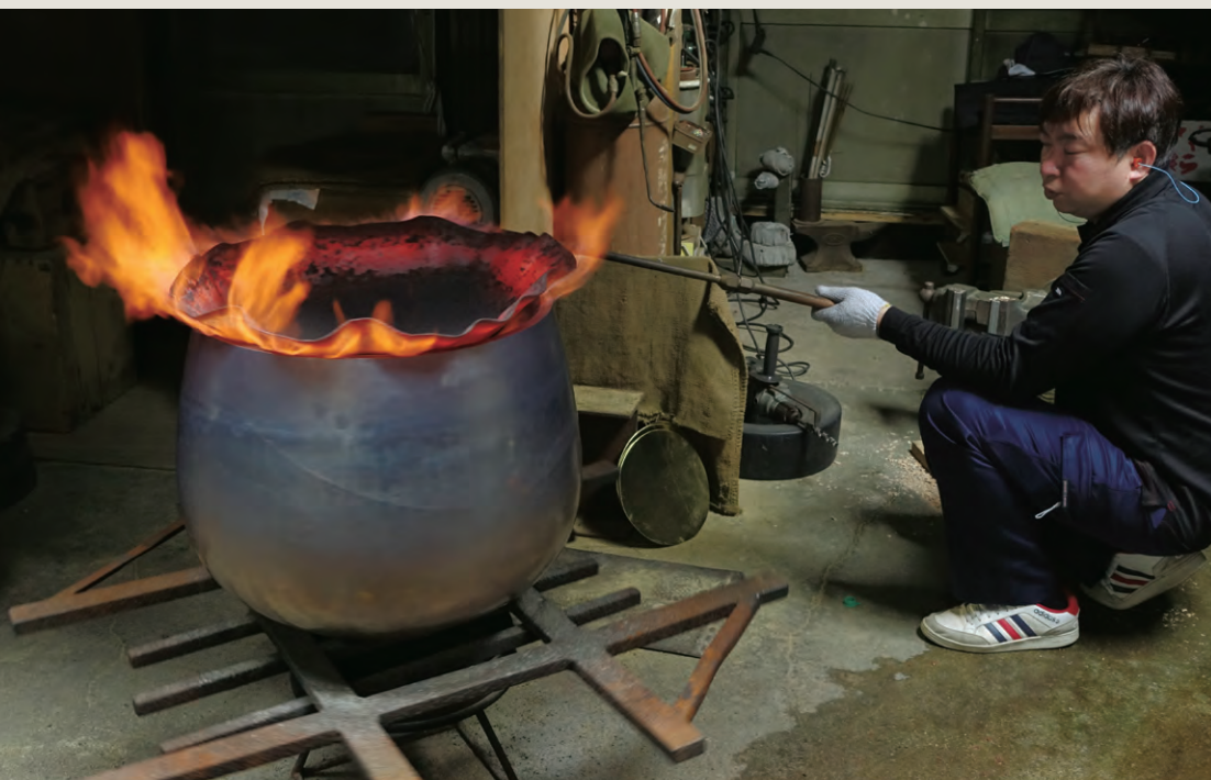
鳴り出し(音の調律工程)。混在する音色を整え、全体として正しく美しく「鳴る」ように、音を聞いては金槌で叩きながら調整してゆく。
