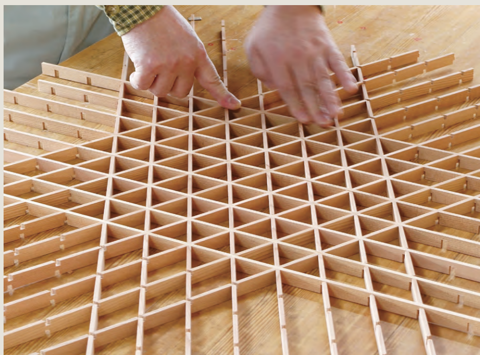
棧の仮組み立て。
