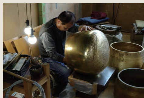
鑿子の仕上げ工程。形を整えた後、さらに厚みを整え仕上げてゆく。
